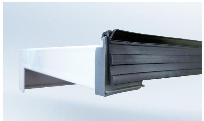
**4** Fensterbankdichtung UD 40–25 über Anschraubsteg und Dichtstück ziehen
